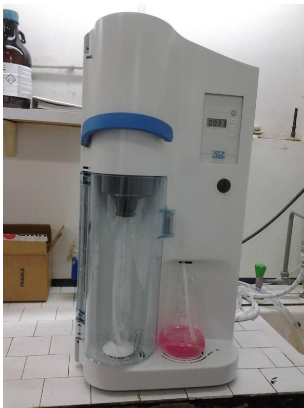
Foto 3.9: distillatore semiautomatico Kjeldahl
