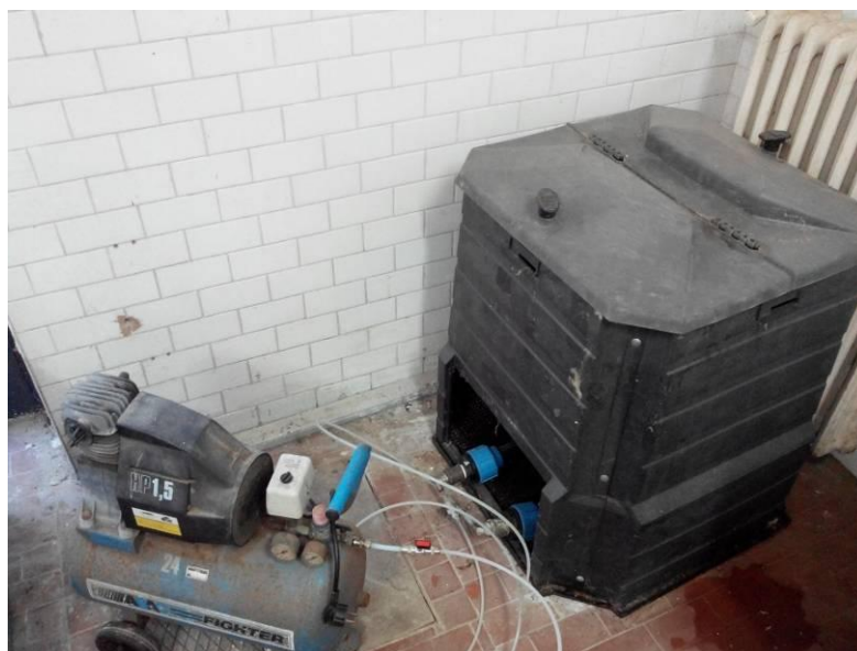
Foto 3.8: Biocomposter utilizzato per il compostaggio di matrici provenienti da rifiuti organici
