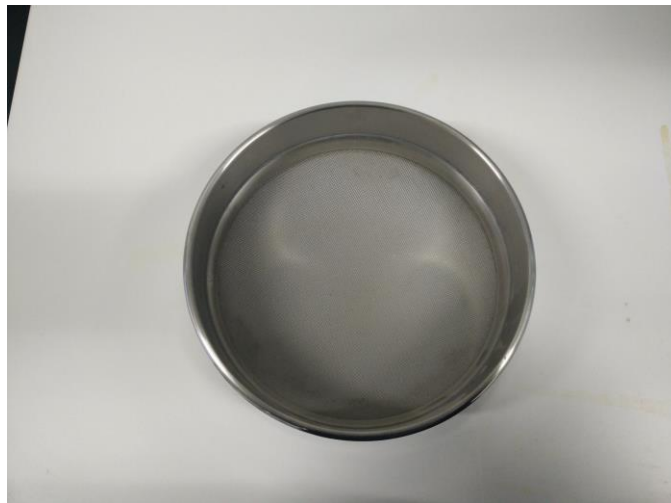
Figura 1. Elemento filtrante utilizzato per la separazione solido/liquido statica.
