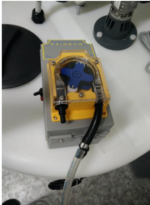
Figura 4. Pompe peristaltiche e tubazioni per il prelievo del liquame.
