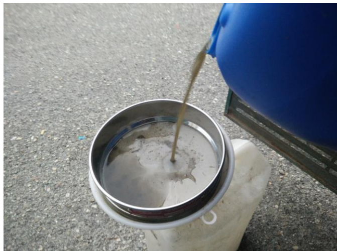
Figura 2. Operazioni di filtrazione del liquame.
