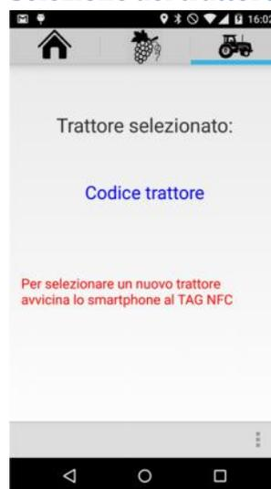
In questa schermata è possibile selezionare il trattore con cui ci si appresta a svolgere la lavorazione semplicemente avvicinando lo smartphone al tag NFC posizionato sul trattore. Una volta riconosciuto apparirà il messaggio con la descrizione del trattore.
