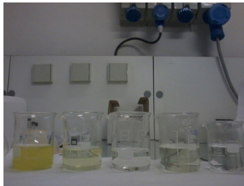
Figura 4.12. Acqua di tinteggio e soluzioni di lavaggio della prova 8
