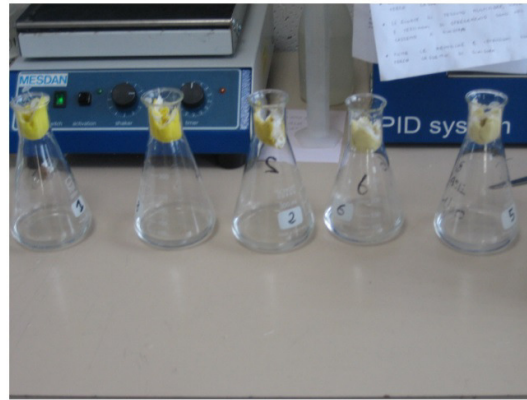
Figura 6.11. Test solidità al sudore alcalino: la bagnatura del campione provetta. A) e B) I campioni provetta vengono inserite in delle indipendenti beute in cui in precedenza sono stati posti 50 ml di sudore sintetico; Le provette vengono quindi immerse con l'ausilio di una bacchetta di vetro e D) messe in agitazione.
