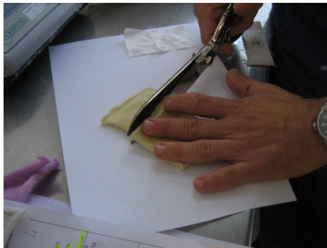
Figura 6.8. Preparazione del campione per i test di solidità al lavaggio e al sudore. Il tessuto viene tagliato in pezzi di opportune dimensione A) e peso B).
