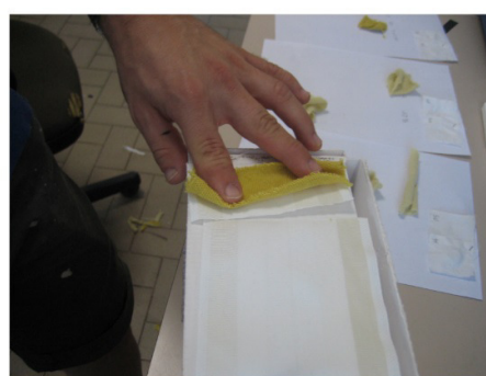
Figura 6.9. Preparazione della provetta composta. A) Nastro di tessuto testimone multifibra; B) Il testimone viene tagliato delle stesse dimensioni del campione da testare; C) Il testimone e campione vengono cuciti in maniera solidale e D) La provetta composta preparata in analoga maniera e vista da lato del testimone in alto e del campione in basso.
