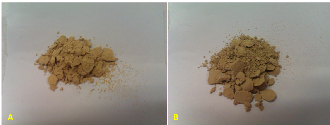
Figura 3. Campioni di idrotalcite ZnAl-NO 3 a contatto con estratto di barbabietola a pH 7 (A) e a pH 8 (B).
