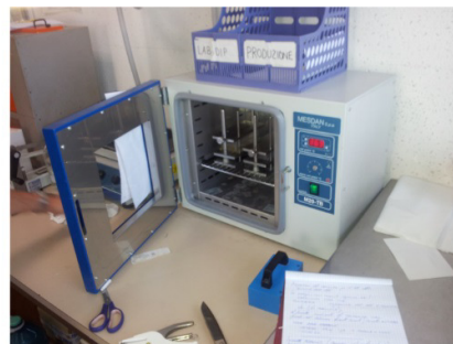
Figure 6.12. Test solidità al sudore alcalino: l'uso del perspirometro. A) Il perspirometro prima dell'uso è composto da delle lastre metalliche che esercitano una pressione sugli strati sottostanti. B) Il campione composto viene rimosso dal bagno alcalino e preparato per essere inserito nel perspirometro, C) sandwich formato dalle varie provette composte D) Il perspirometro viene chiuso e applicata una pressione definita quindi il tutto viene termostato per 4 ore.
