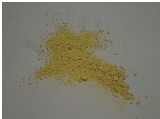
Figura 4.5. HTlc ZnAl ottenuta dopo contatto con il bagno tintorio di Reseda lutea
