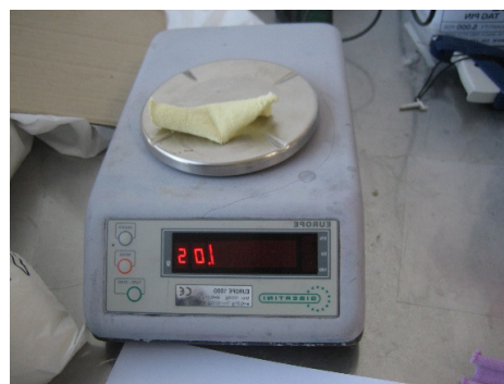
Figura 6.8. Preparazione del campione per i test di solidità al lavaggio e al sudore. Il tessuto viene tagliato in pezzi di opportune dimensione A) e peso B).
