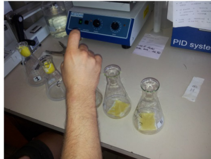
Figura 6.10. Test Solidità al lavaggio a umido. A) L’etichetta del detergente ECE, B) Fase di immersione della provetta composta nella beuta con la soluzione che mima il lavaggio domestico e commerciale, C) La condizione di lavaggio viene mantenuta per 40 minuti monitorando continuamente la temperatura (40 gradi). Dopo il tempo indicato la provetta composta viene aperta e asciugata per le successive valutazioni.
