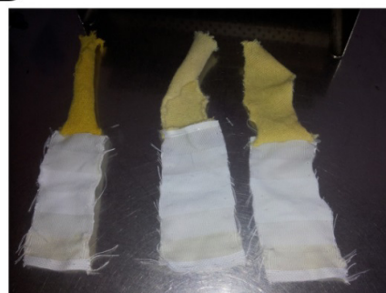
Figura 6.10. Test Solidità al lavaggio a umido. A) L’etichetta del detergente ECE, B) Fase di immersione della provetta composta nella beuta con la soluzione che mima il lavaggio domestico e commerciale, C) La condizione di lavaggio viene mantenuta per 40 minuti monitorando continuamente la temperatura (40 gradi). Dopo il tempo indicato la provetta composta viene aperta e asciugata per le successive valutazioni.
