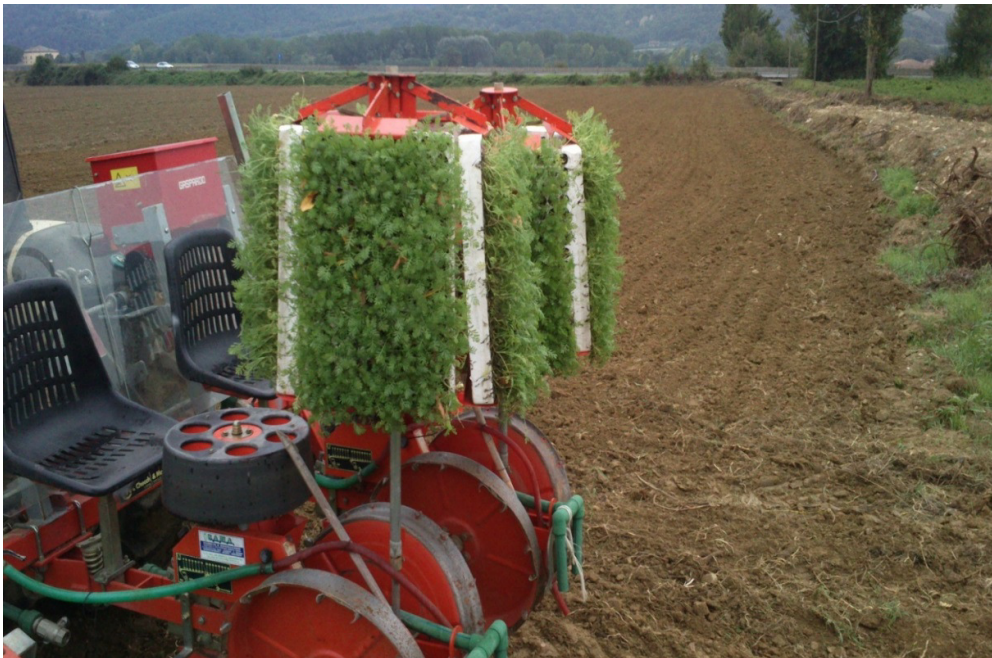
Figura3.5. Cantiere manuale a trazione meccanica per il trapianto equipaggiato con piantine di Anthemis tinctoria
